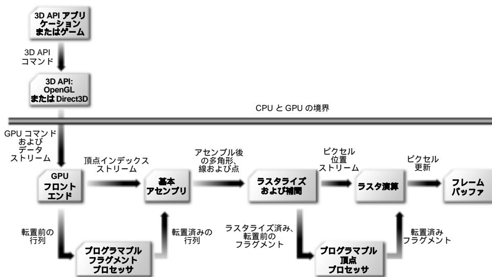
図 1 Cg の GPU のモデル
